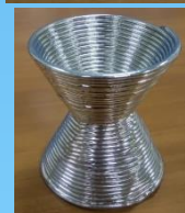
3Д модели и напечатанные изделия из алюминия, полученные методом аддитивного формообразования из расплава
